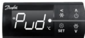
Przez 3 sekundy wyświetlany jest komunikat „Pud” sygnalizujący wychładzanie. Podczas wychładzania miga ikona WYCHŁADZANIA.
