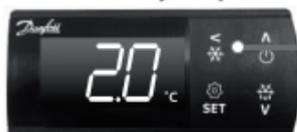
**PULL DOWN (ЗАХОЛАЖИВАНИЕ):** нажмите на 3 секунды для инициирования захлаживания.
