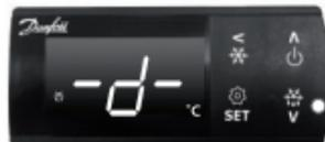
ODTAJANIE: naciśnij przycisk i przytrzymaj go przez 3 sekundy, aby zatrzymać ręczne odtajanie. Podczas odtajania wyświetlana jest ikona ODTAJANIA.
