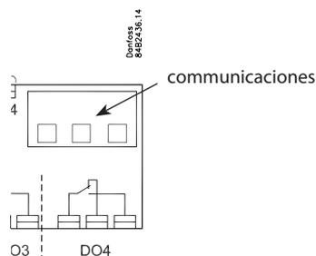
MODBUS o LON-RS485 mediante tarjetas de inserción.
