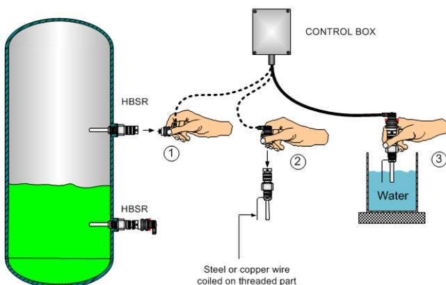
Si la parte electrónica funciona según lo previsto durante la prueba, se puede excluir la posibilidad de una avería en el sensor.
