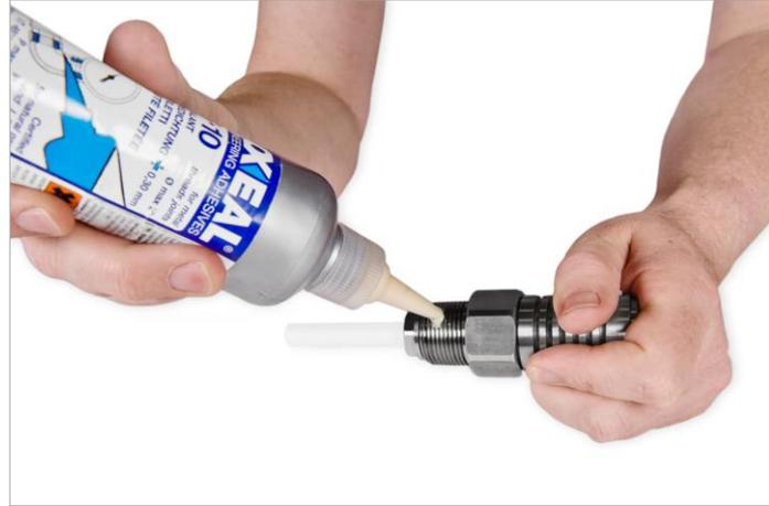
Aplique junta líquida en sensores con rosca cónica y junta sólida en sensores con rosca cilíndrica.
