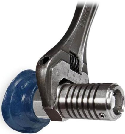
Instale la parte mecánica en el contenedor o tubo de desagüe y apriétela según el tipo de rosca (80-150 Nm).
