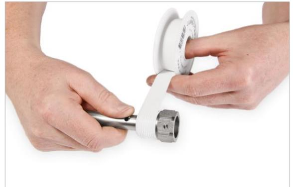
*Aplique Teflon o junta líquida en el sensor con rosca cónica. Para otros tipos de rosca se emplean juntas sólidas.*
