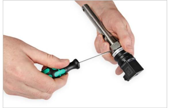
*Afloje los dos tornillos para poder desmontar la parte electrónica. En modelos sin tornillos, empuje la parte electrónica hacia la mecánica y gire la cubierta en sentido antihorario hasta que la arandela ondulada se desplace de la posición de montaje.*
