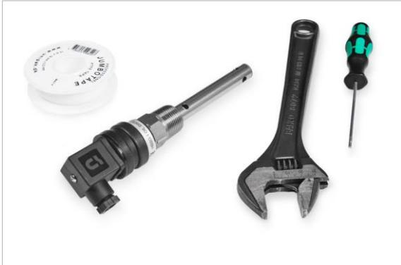
*La instalación de HBSOxxx con rosca cónica requiere cinta de Teflon/junta líquida, una llave inglesa o fija NW de 27, 32 o 36 mm (dependiendo del tipo de rosca) y una llave Allen de 2,5 mm.*
