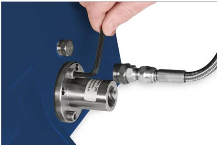
Instale la brida en la cubierta del compresor. Use una junta tórica de  $\varnothing 32 \times 2,5$  (no incluida con la brida).
