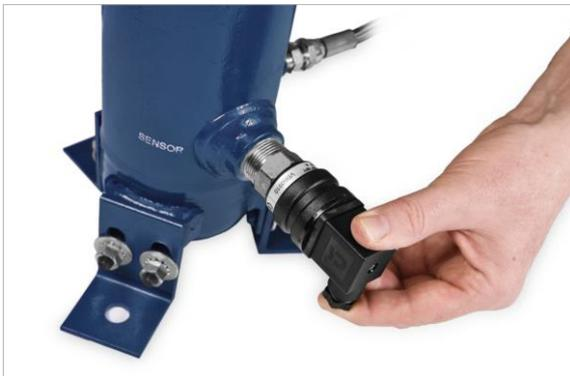
*Vuelva a instalar la parte electrónica con tornillos o gírela para montarla. Aplique una pequeña presión para vencer la fuerza de la arandela elástica instalada en la parte mecánica.*
