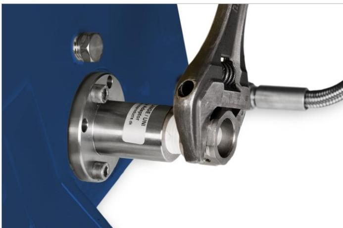
Aplique Teflon o junta líquida a la parte mecánica del sensor y fijela a la rosca interior de la brida.
