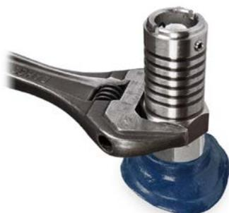
Monte la parte electrónica en el contenedor o en el tubo de desagüe y apriétela (80-150 Nm).
