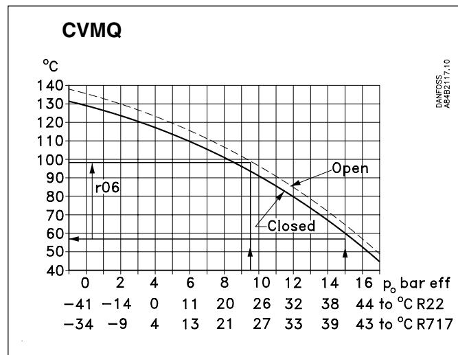
Die beiden Kennlinien gelten für die der Werkseinstellung entsprechende Federeinstellung des Ventils. Wird die Federeinstellung auf einen höheren Druck verändert, verschiebt sich die Kennlinie mit einer entsprechend höheren Temperatur.
