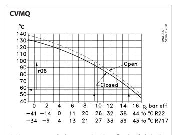
Las dos curvas estan realizadas para una ajuste de muelle en las válvulas igual al ajuste de fábrica. Si el ajuste del muelle varía a una mayor presión la curva se desplazará hacía mayores temperaturas.
