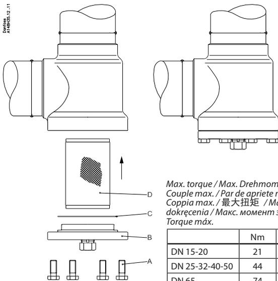
Max. torque / Max. Drehmoment /
